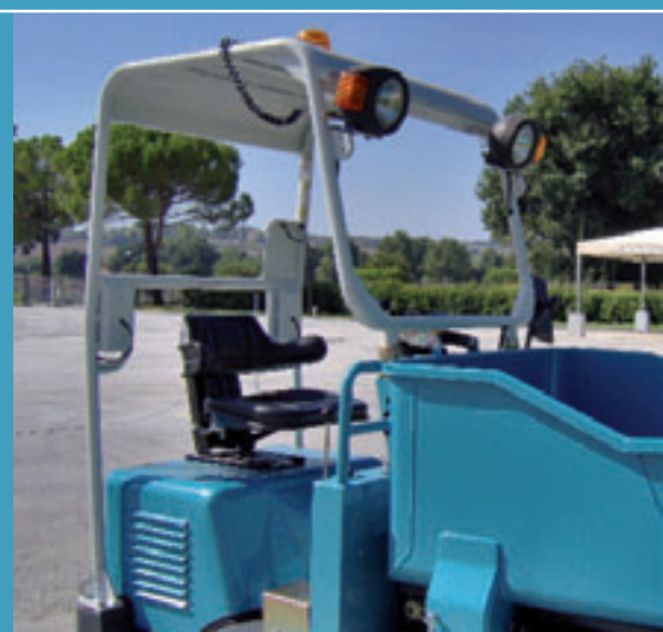
ROPS-FOPS canopy (for on road use also) / Schutzdach ROPS-FOPS mit Strassenzulassung / Навес ROPS-FOPS (также для применения на дорогах)
