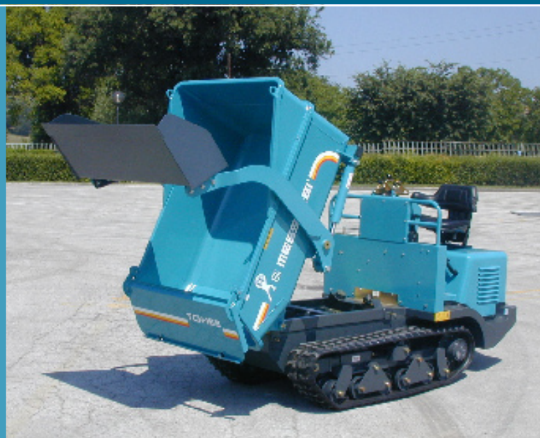
Frontal dumping skip with (without) selfloading shovel / Pritsche mit frontaler Kippung mit / ohne Selbstladeschaufel / Бункер с фронтальной разгрузкой, возможна комплектация самопогрузчиком.
