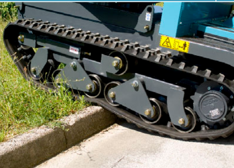
Details of the track swing / Detail Raupenschwingung / Узел гусеничной подвески
