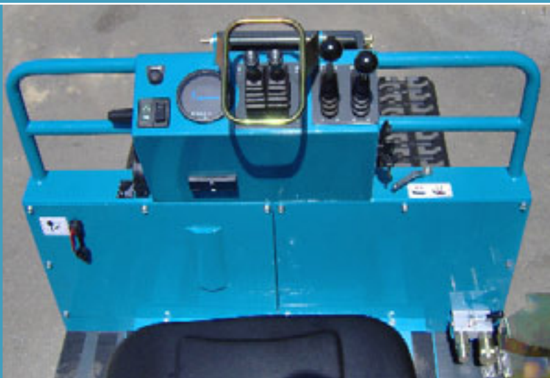
Details of the dashboard with controls and hydraulic P.T.O. / Detail Instrumentenbrett und Nebenantrieb / Гидравлический отбор мощности с приборной панелью и средствами управления.
